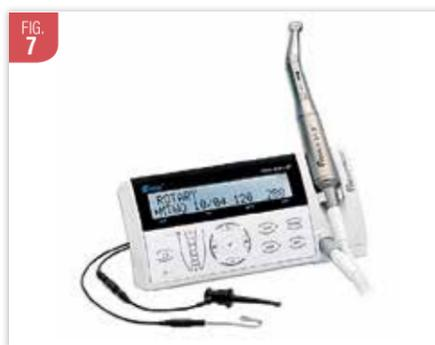
préparation canalaire ainsi que la détermination de la LT se font de manière simultanée. Le praticien peut choisir entre la fonction « Auto Apical Stop », ce qui entraîne un arrêt de la lime lorsque le « 0 » est atteint, et « Auto Apical Reverse », ce qui entraîne une inversion de la rotation de la lime lorsque le « 0 » est atteint (9).
